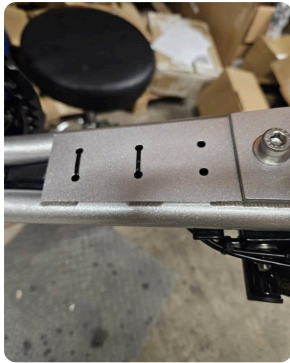
La plaque de la poutre, derrière le moteur, et ses trous.
