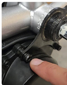
Monté : la plaque est décalée du carter par les deux entretoises.
