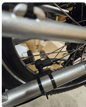
Capteur sur la base gauche : scotch noir sous les deux colliers.
