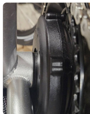
Moteur inséré : les deux entretoises entre la plaque et le carter.
