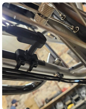
L'entretoise et la vis de 35 mm déportent le capteur vers la roue.
