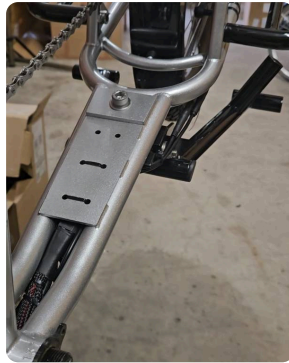
Le faisceau arrive sous la plaque.
