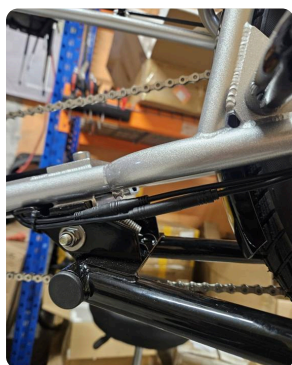
Les connecteurs capteur et feu arrière, au support de béquille.
