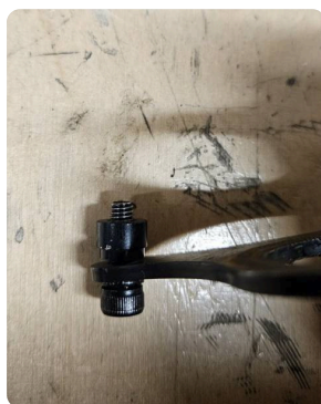
L'empilage sur une patte : vis, plaque, grande et petite entretoises.
