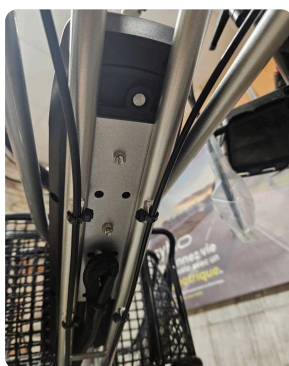
Les trous du socle servent à passer les colliers.
